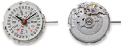
6T51 厚度 5.98 毫米 / 21 钻 频率 28800 次 / 小时 自动上条 / 手动上条 快速日历设定
