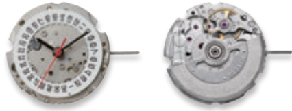
6T15 厚度 5.98 毫米 / 21 钻 频率 28800 次 / 小时 自动上条 / 手动上条 快速日历设定
