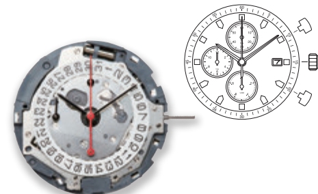
0S60 厚度 4.13 毫米 计时 (时/分/秒) / 1/20 秒 电池寿命二年 (SR927W)
