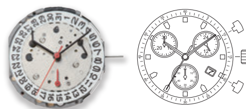
JS05 厚度 4.30 毫米 计时 (30 分 / 秒) / 24 小时 电池寿命三年 (SR621SW)
