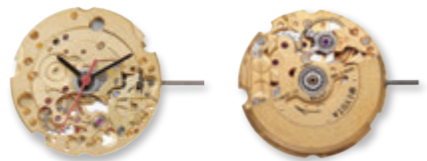
6T28 金色 厚度 5.23 毫米 / 21 钻 频率 28800 次 / 小时 自动上条 / 手动上条 裸摆
