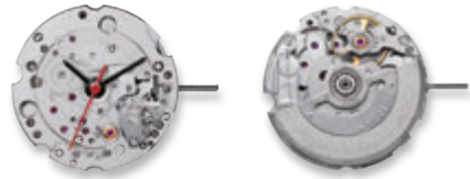
6T27 厚度 5.23 毫米 / 21 钻 频率 28800 次 / 小时 自动上条 / 手动上条
