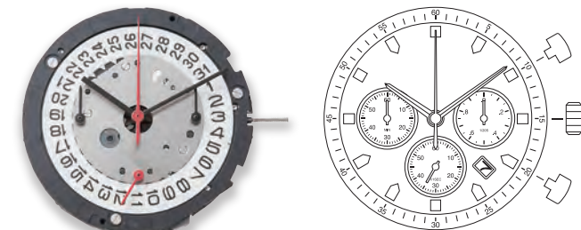
6S20 厚度 4.90 毫米 计时 (分 / 秒) / 1/20 秒 电池寿命四年 (SR927W)
