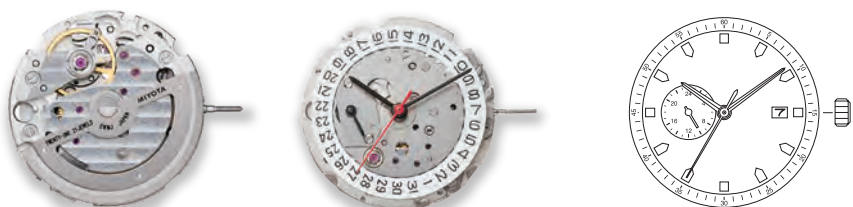
8217 厚度 5.67 毫米 / 21 钻 频率 21600 次 / 小时 止秒功能 自动上条 / 手动上条 快速日历设定
