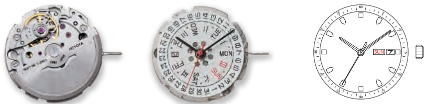
8205 厚度 5.67 毫米 / 21 钻 频率 21600 次 / 小时 止秒功能 自动上条 / 手动上条 快速星期 / 日历设定
