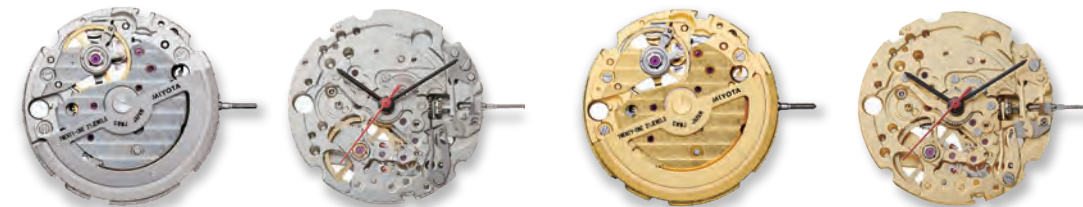
8250 厚度 5.67 毫米 / 21 钻 频率 21600 次 / 小时 止秒功能 自动上条 / 手动上条
