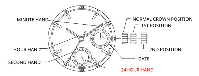
NORMAL CROWN POSITION 1ST POSITION 2ND POSITION QUICK OPERATION - DATE (COUNTERCLOCKWISE)
